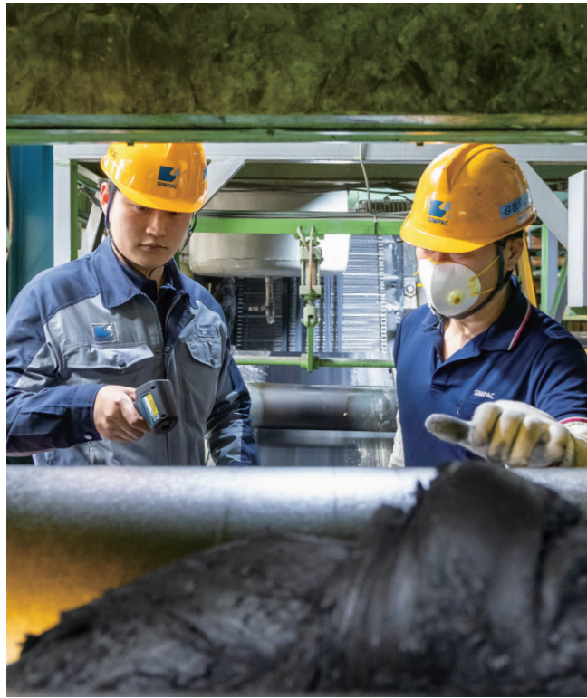
정련반에서 배합 중인 고무 반죽의 상태를 체크하는 모습
