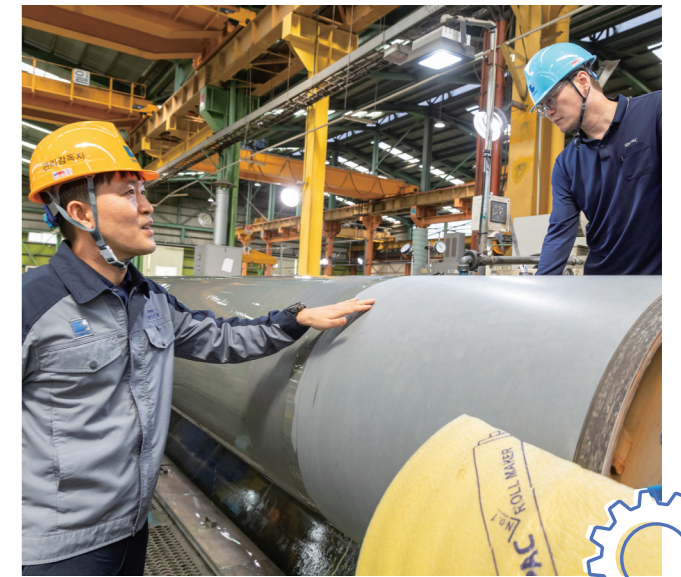
제지를 정밀 연마 중 표면 상태를 체크하는 모습
